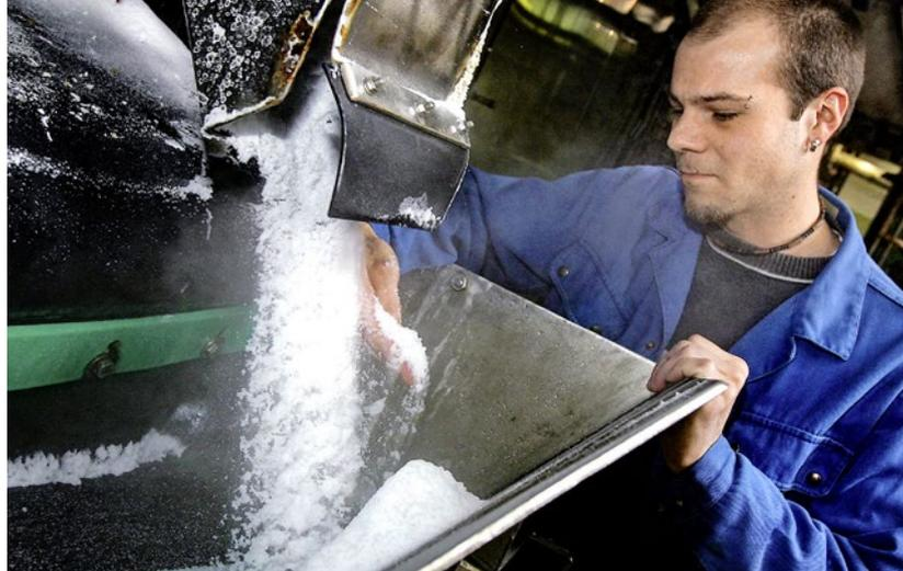
Das nach dem Trocknungsprozess noch heisse Salz wird von einem Mitarbeiter der Saline geprüft.
