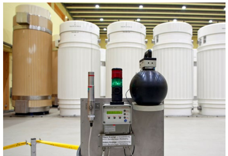
Contenedores para residuos altamente radiactivos, en el centro de almacenamiento provisional de Würenlingen, con medidores de control en primer plano. Foto Keystone
